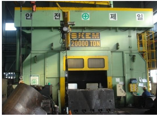
Tee Bulging Press 20,000 Ton
